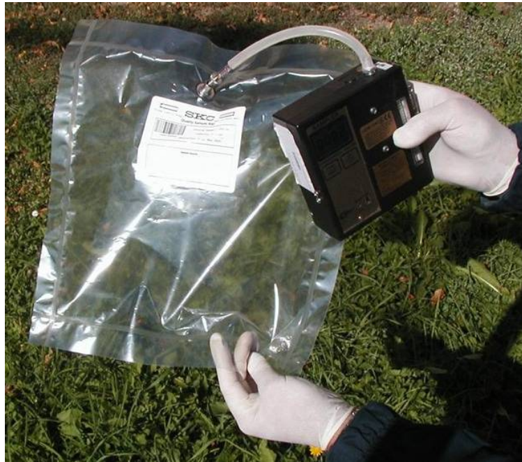
Obr. 1: Odběr vzorků vzduchu do vzorkovacího vaku pomocí plynového odběrového čerpadla
