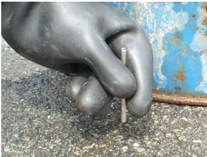
Obr. 2: Pasivní vzorkování par nad hladinou kapaliny
