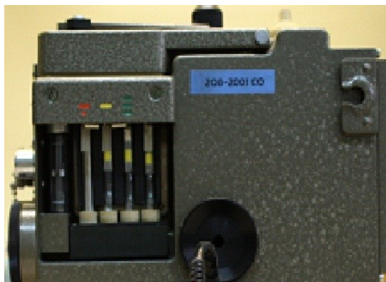
Obr. 4: Odběr vzorků vzduchu na sorpční trubičku pomocí chemického průkazníku CHP-71
