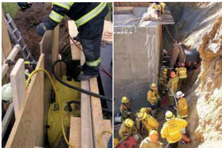
Obrázek 19, Použití nízkotlakých a středotlakých vaků u zásahu [5,6]
