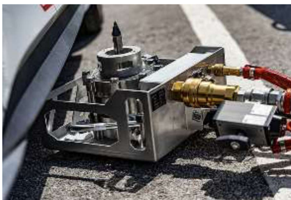
Hasicí systém s penetrací baterie
