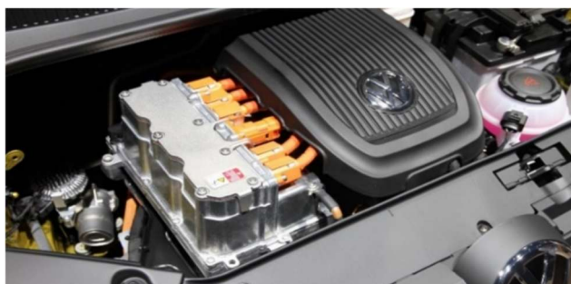
Obrázek 16 – „HV“ rozvody viditelné v motorovém prostoru
