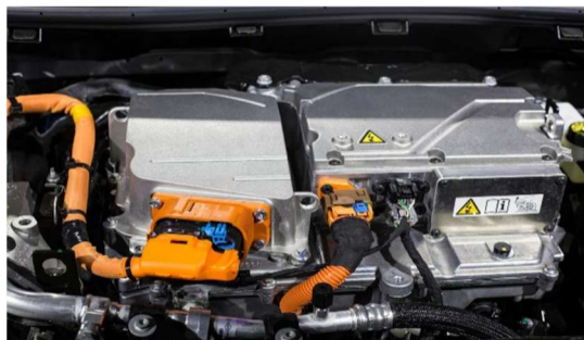
Obrázek 16 – „HV“ rozvody viditelné v motorovém prostoru
