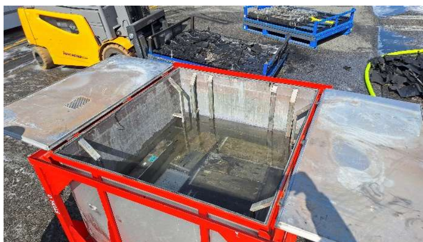
Obrázek 30 – Zaplavené nestabilní moduly po požáru
