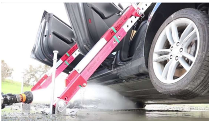
Obrázek 25 – Polohování vozidla při chlazení baterií
